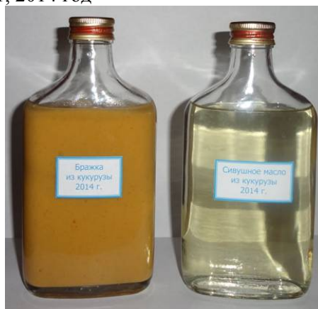
Рис. 4. Внешний вид бражки и сивушного масла (спиртзавод ООО «Стандарт Спирт», г. Нарткала)
