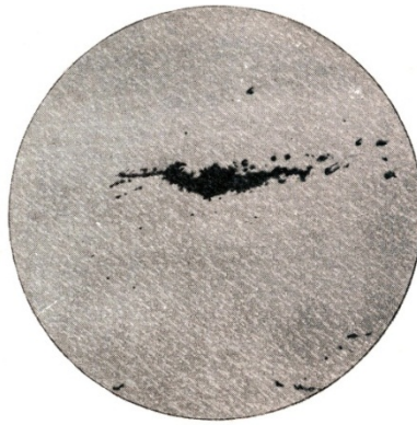
Рисунок 4 –Поры в стали
