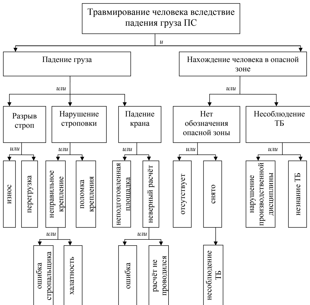
Рисунок 1. Причины травмирования человека вследствие падения груза при эксплуатации ПС
