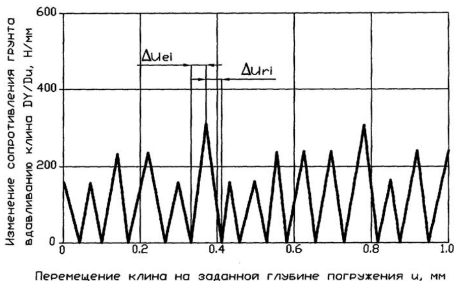
Рисунок 2 – График циклически изменяющегося сопротивления грунта вдавливанию клиновидного индентора
