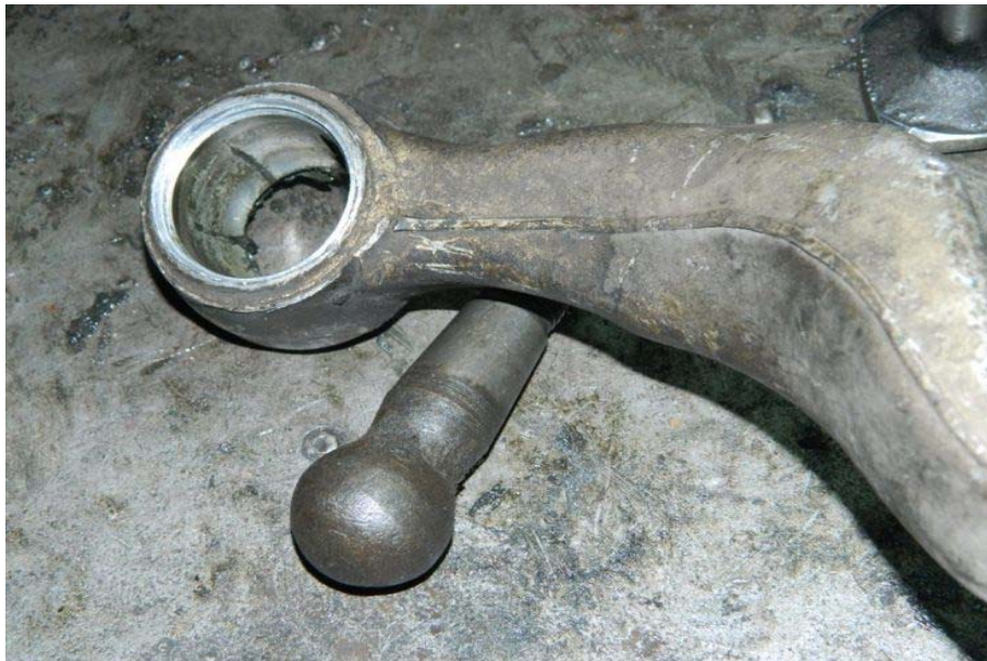
Рисунок 1 - Внешний вид изношенного, загрязненного "пальца" шаровой опоры.
