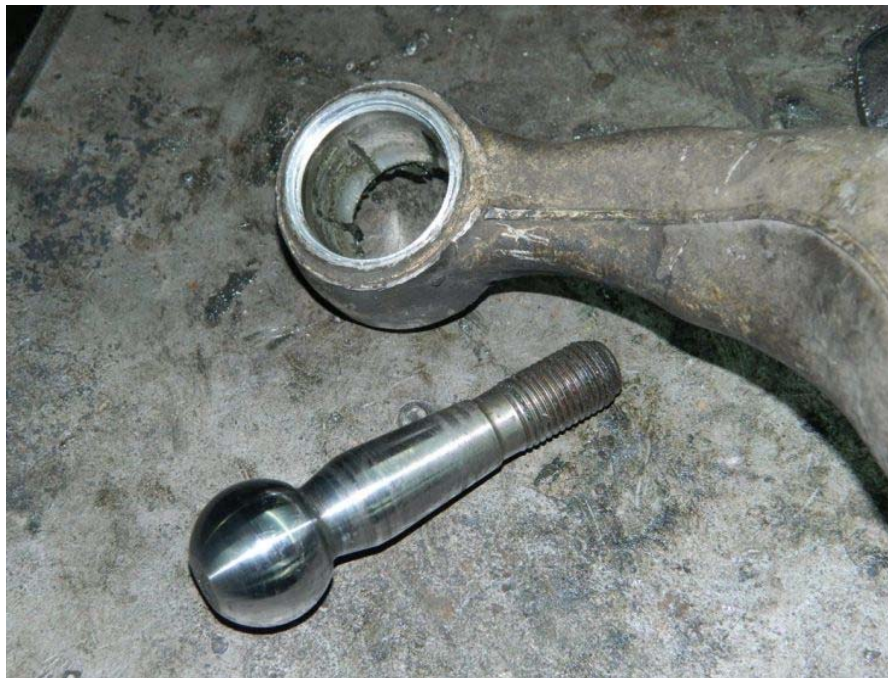
Рисунок 3 - Восстановленная шаровая опора и «палец», восстановленный шлифованием.
