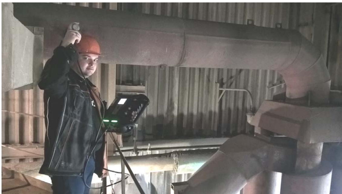
Рисунок 2 – Определение запыленности дымовых газов на выходе из циклона (Автор Бушумов С.А. при проведении замеров циклона ЦН-15-500).
