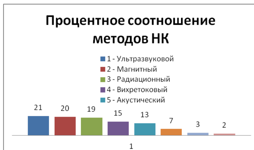
Рисунок 2- Гистограмма процентного соотношения применяемых методов НК при диагностике сварных соединений.
