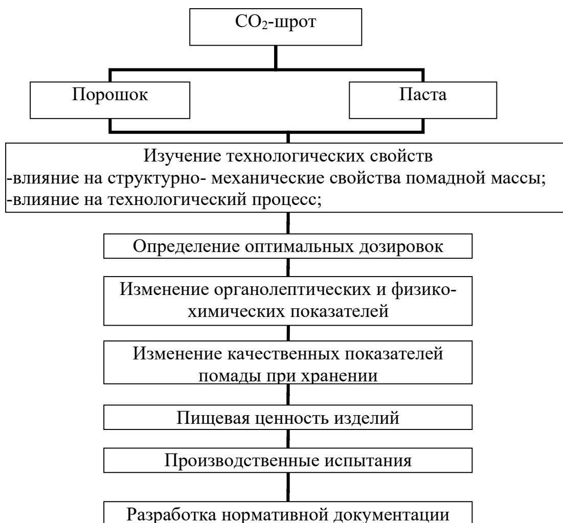
Рисунок 1.1 – Схема проведения исследований
