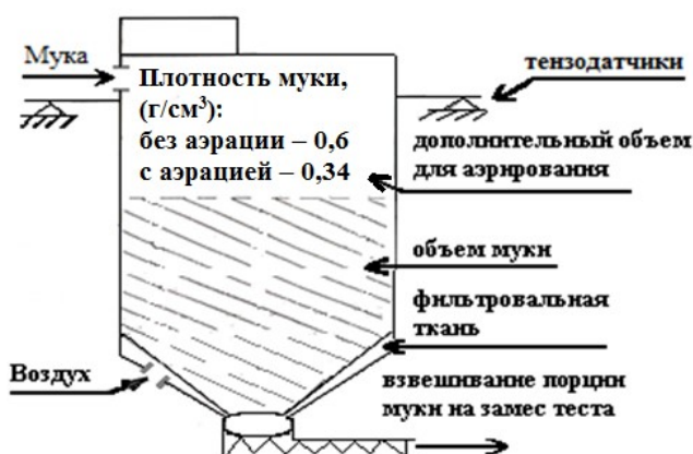
Рисунок 2 – Принципиальная схема весового устройства
