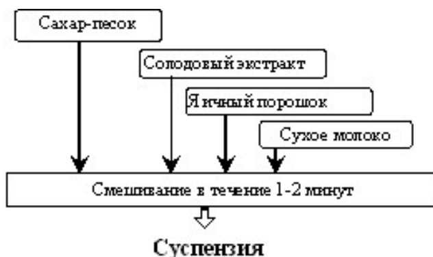
Рисунок 3 – Технологическая схема получения суспензии
