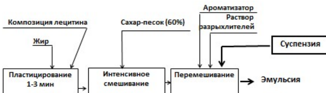
Рисунок 4 - Технологическая схема приготовления эмульсии
