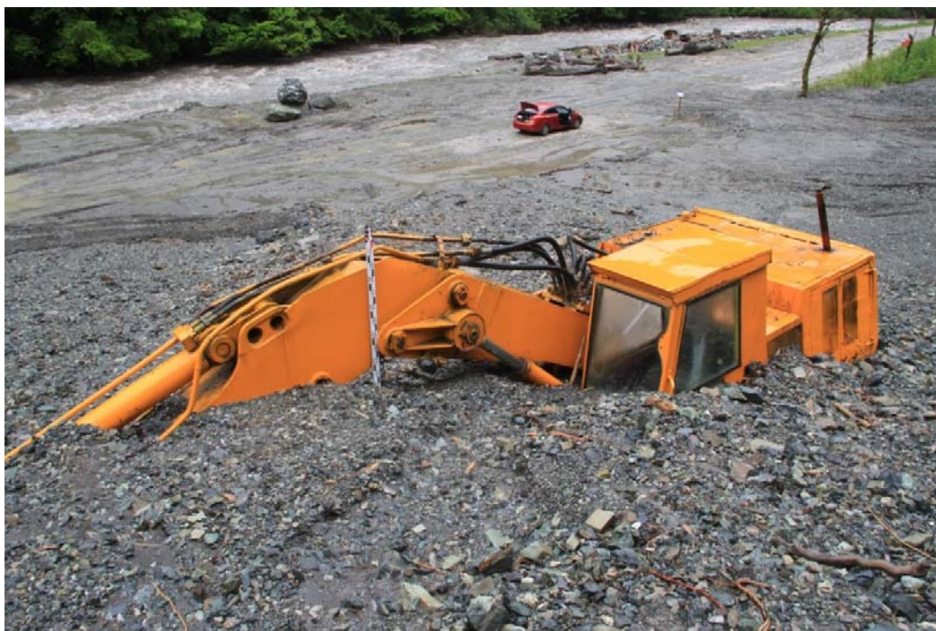
Рисунок 5 – Конус выноса селя с водотоков 5 и 6 сошедшего на дорогу № 23 горного курорта «Роза – Хутор» в апреле 2017 года и похоронивший экскаватор (фото автора).
