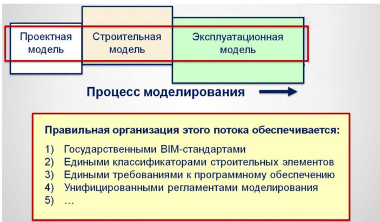
Рисунок 2 – Непрерывность BIM моделирования.
