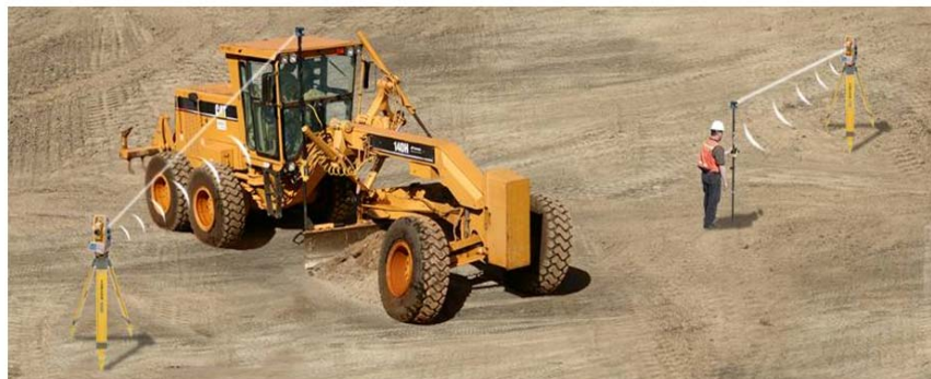
Рисунок 4 – 3D система на основе электронного тахеометра [5].
