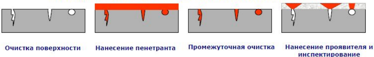
Рис. 1. Последовательность операций при капиллярном контроле.
