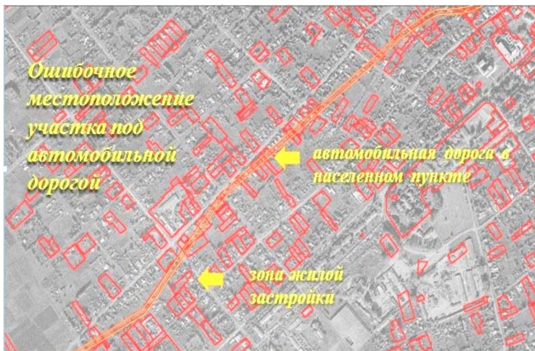
Рисунок 1- Наложение границ земельного участка автомобильной дороги на смежные земельные участки индивидуальных жилых строений.
