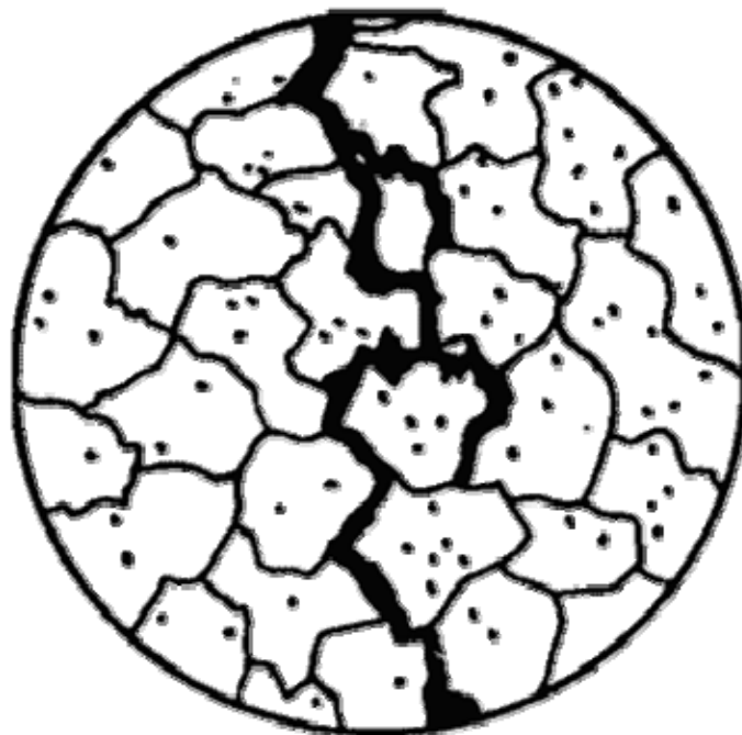
Рис.1. Схема развития межкристаллитной коррозии.
