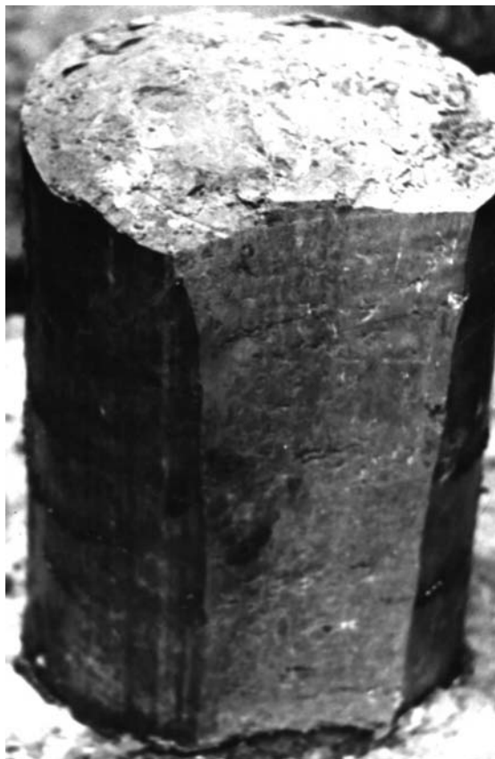
Рис. 8. Монолит глины твёрдой трещиноватой
