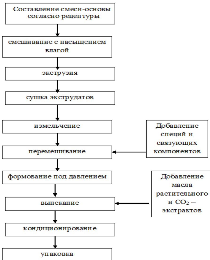
Рисунок 2. Технологическая схема производства воздушных крипсов путем двойной экструзии
