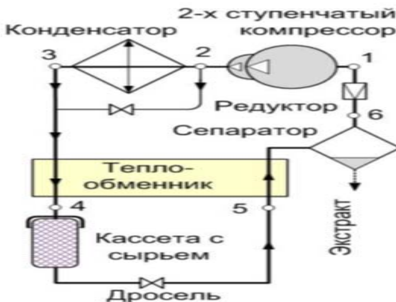
Рисунок 4 – Принципиальная схема установки для сверхкритической CO 2 -экстракции
