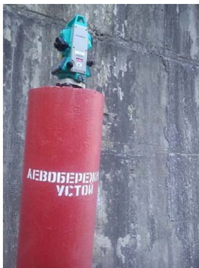
Рисунок 1 – Общий вид пункта ОГС ГЭС
