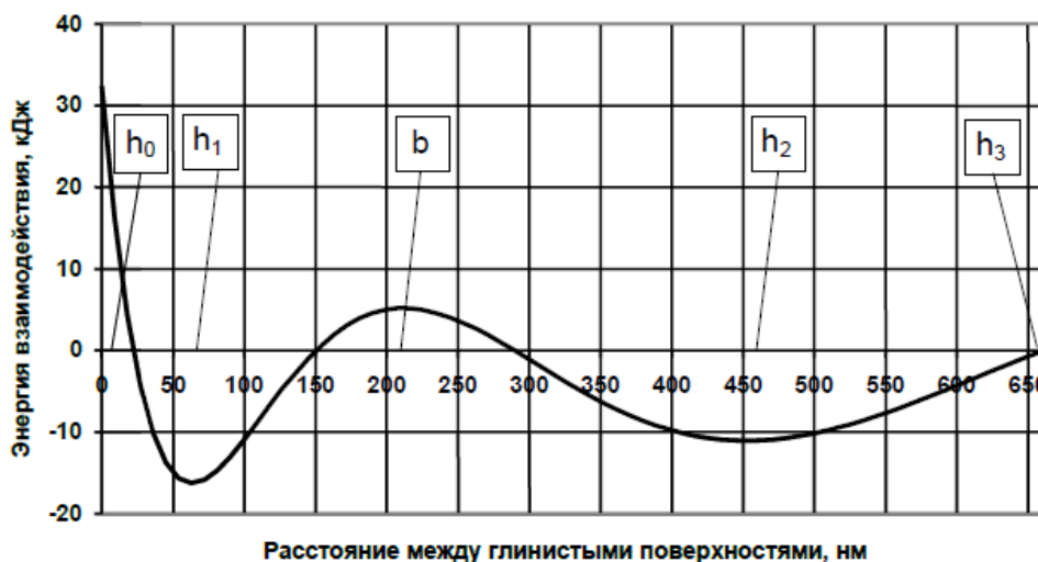
Рисунок 3 – График зависимости энергии взаимодействия глинистых поверхностей от расстояния между ними по данным статического зондирования твердого суглинка цилиндрическим индентором
