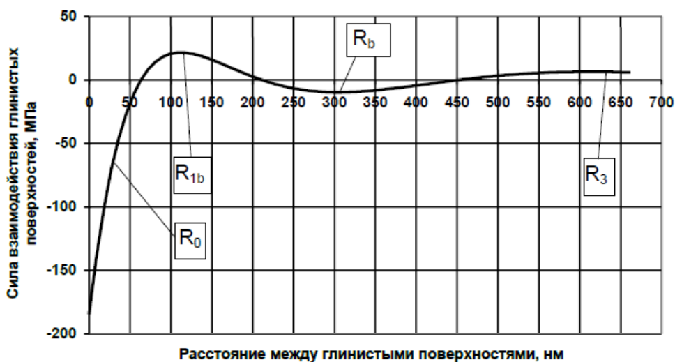
Рисунок 4 – График зависимости силы взаимодействия глинистых поверхностей от расстояния между ними по данным статического зондирования твердого суглинка цилиндрическим индентором
