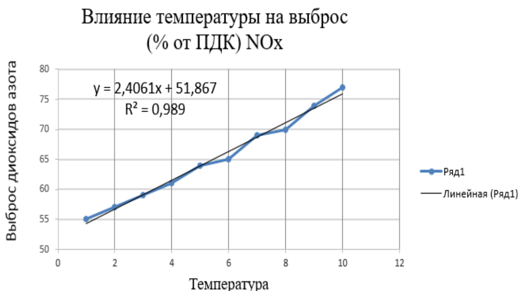
Рисунок 1 – Влияние температуры сжигания газа на выброс оксидов азота
