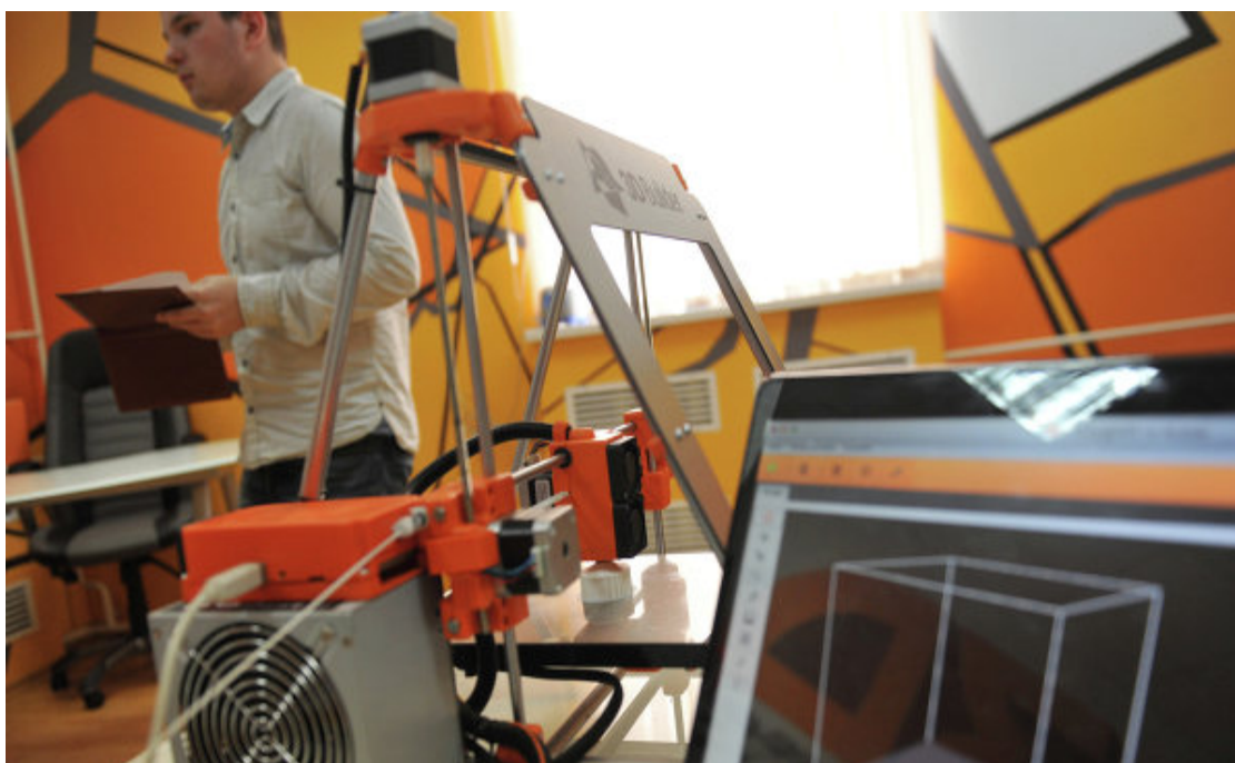
Рис.3 Опытный образец 3D-принтера для печати шоколада
