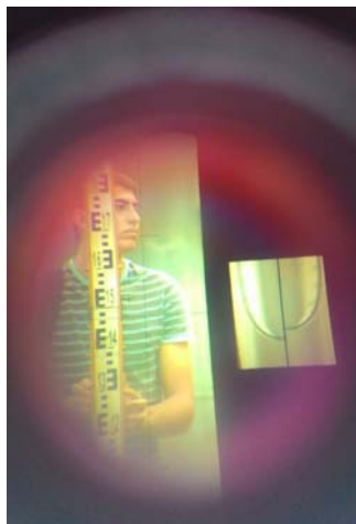
Рисунок 4 – поле зрения работающего с нивелиром: изображение со зрительной трубы, реечник с рейкой, контактный уровень нивелира (не совмещен на изображении), сетка нитей.
