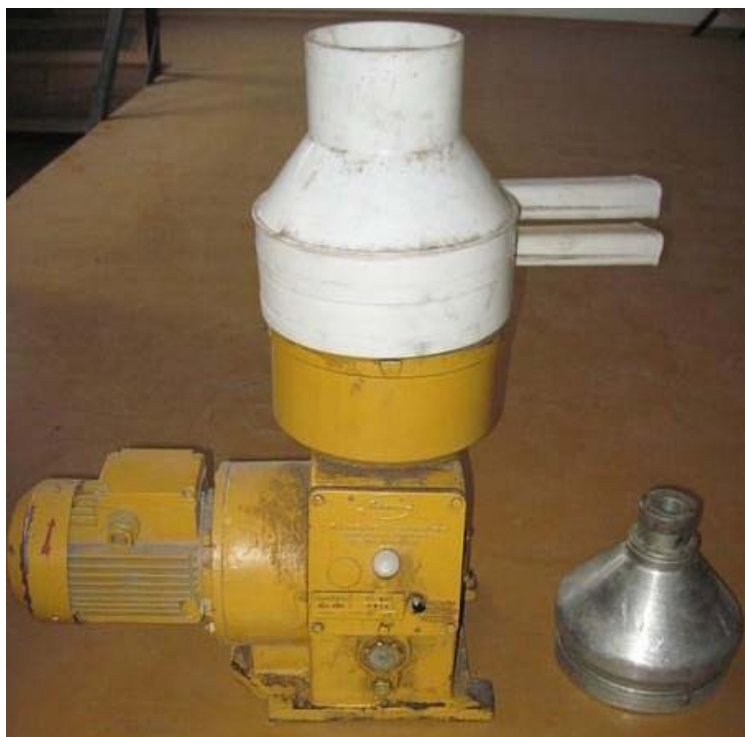
Рисунок 3 – Сепаратор-сливкоотделитель типа ОСБ
