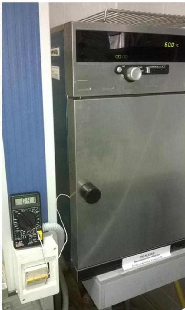
а) показание конечной температуры прогрева воды при температуре в шкафу 60 °С
