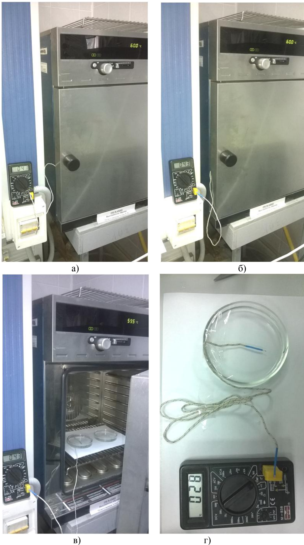
конечная температура прогрева: а) одна чашка Петри; б) и в) две чашки Петри; г) начальное показание температуры цифрового мультиметра Mastech (две чашки Петри) Рисунок 2 – Наглядное исполнение экспериментов и показания приборов
